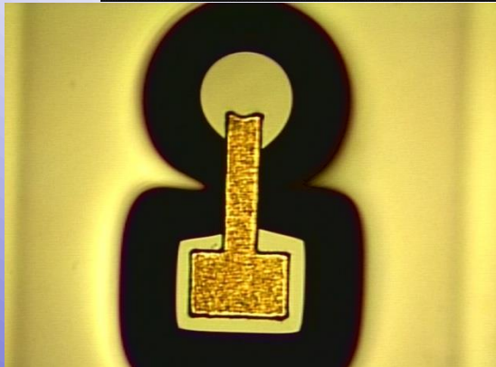
Рис. Р-і-п-фотоприемники созданные по «мостиковой» технологии: слева - без диэлектрической изоляции, справа - с диэлектрической изоляцией
