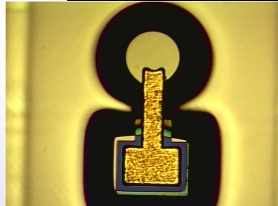
Рис. Р-і-п-фотоприемники созданные по «мостиковой» технологии: слева - без диэлектрической изоляции, справа - с диэлектрической изоляцией
