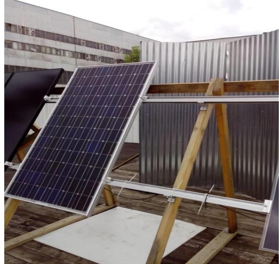
Угол наклона модулей  $70^\circ$
