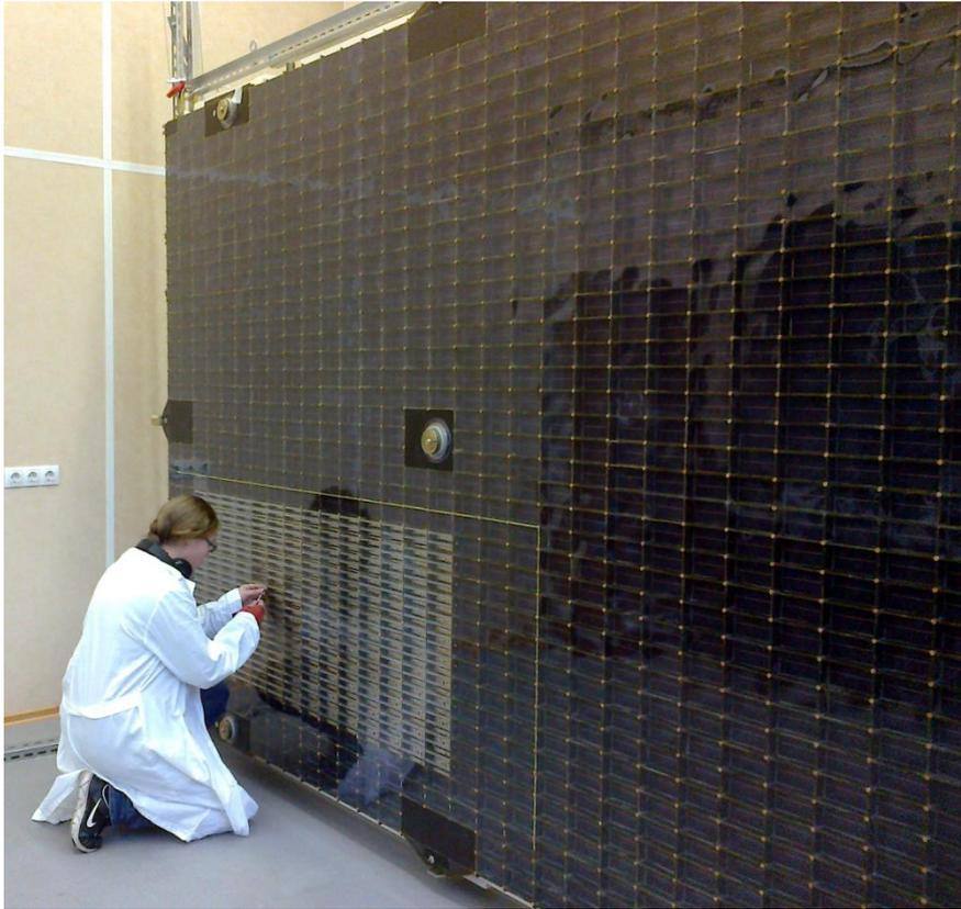
Макет первой отечественной солнечной батареи (10м<sup>2</sup>) с линзовыми концентраторами излучения и каскадными солнечными элементами на несущем углепластиковом каркасе, предназначенный для проведения комплекса предполетных испытаний
