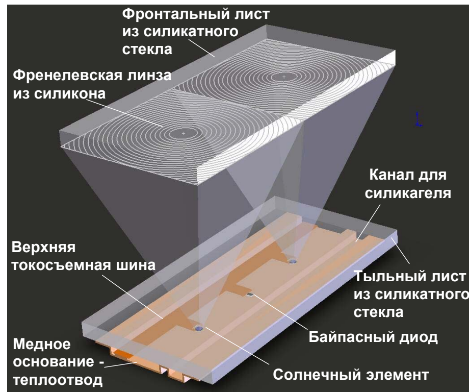
Схема концентраторного модуля с минилинзами Френеля
