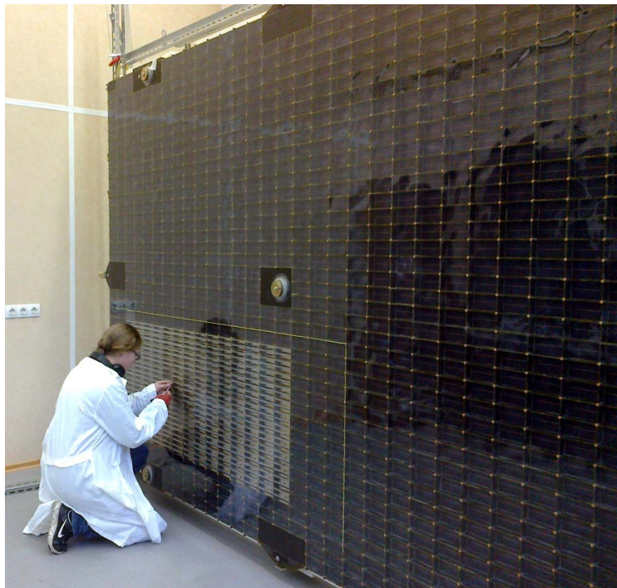
Макет первой отечественной солнечной батареи (10м 2 ) с линзовыми концентраторами излучения и каскадными солнечными элементами
