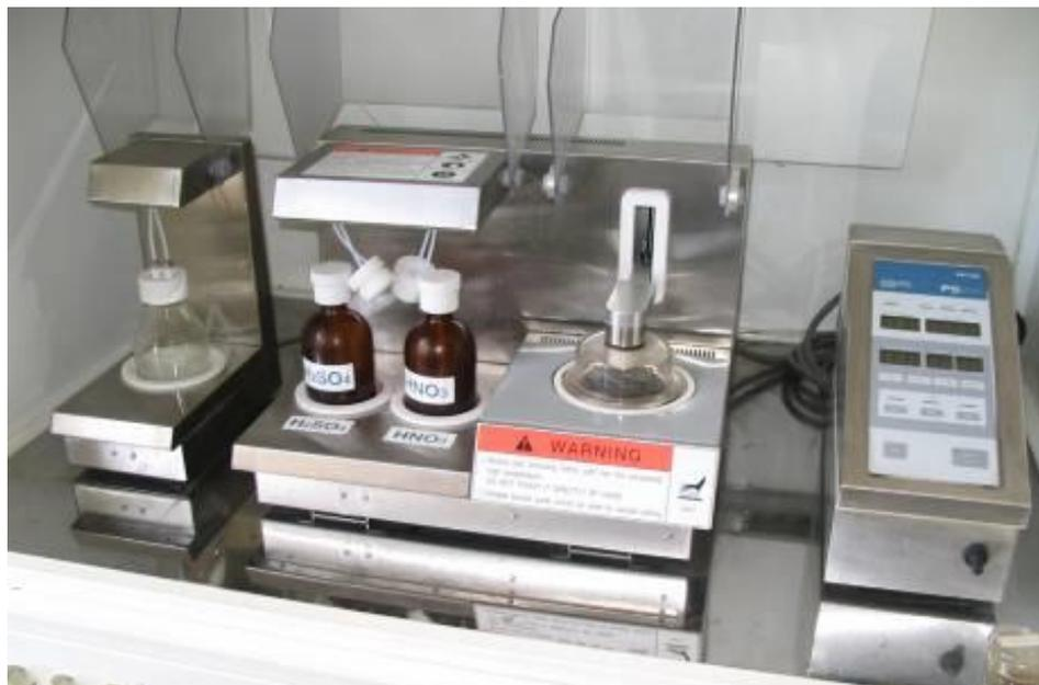
Локальное вскрытие корпусов микросхем с сохранением работоспособности микросхем
