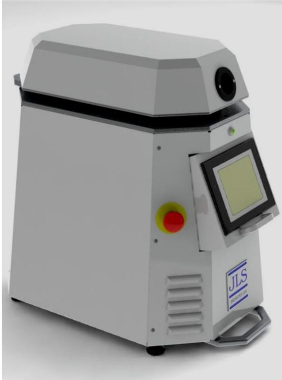
рабочие газы -  $CF_4$ ,  $C_3F_8$ ,  $O_2$ ; частота ВЧ генератора- 13,56 МГц
