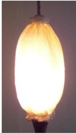
Эмиттер типа «mantle» для сжигания потока газа под оболочкой, полученной с использованием растворов, содержащих редкоземельные компоненты (Yb, Er, Y). Оболочка фиксируется керамическими кольцами  $AlO_x$  на металлическом стержне.
