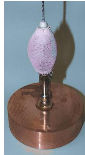
Спектры излучения селективного эмиттера (фото) на основе  $Y_2O_3$  с покрытием  $Er_2O_3$  или  $Yb_2O_3$
