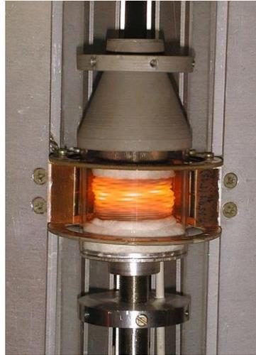
Зона сгорания топлива в термофотоэлектрическом генераторе
