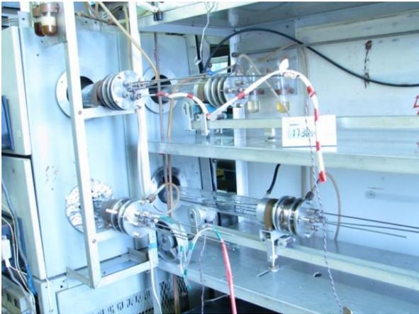
Установка жидкофазной эпитаксии для проведения ростовых и диффузионных процессов
