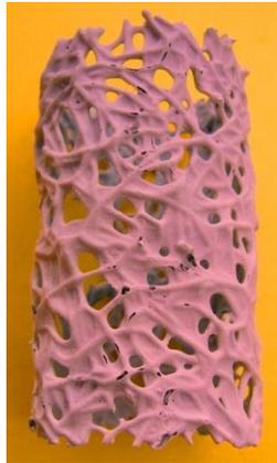
Эмиттер на основе  $SiC$  без покрытия, с покрытием иттербием и эрбием.
