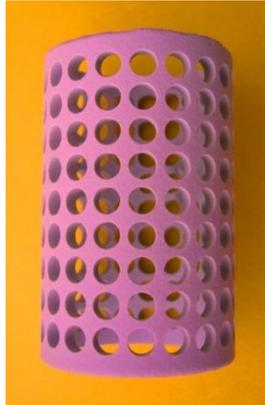
Цилиндрические перфорированные эмиттеры на основе дисилицида молибдена  $MoSi_2$  без покрытия и с дополнительным нанесением  $Er_2O_3$ . Термически устойчивы в потоке газа и температуре до  $1700\text{ }^{\circ}C$ .
