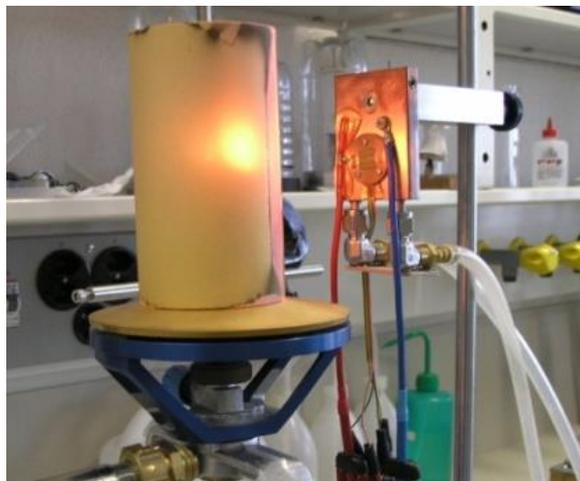
*Лучшую комбинацию дают преобразователь ФТИ им. А.Ф. Иоффе и эмиттер Er2O3 (153 мВт/см<sup>2</sup> в сравнении с 125 мВт/см<sup>2</sup> для фотоэлемента JX Crystals).*
