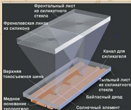
Рис. 4. Схема части концентраторного модуля на основе малоразмерных линз Френеля и каскадных фотопреобразователей, расположенных в фокусе линз.
