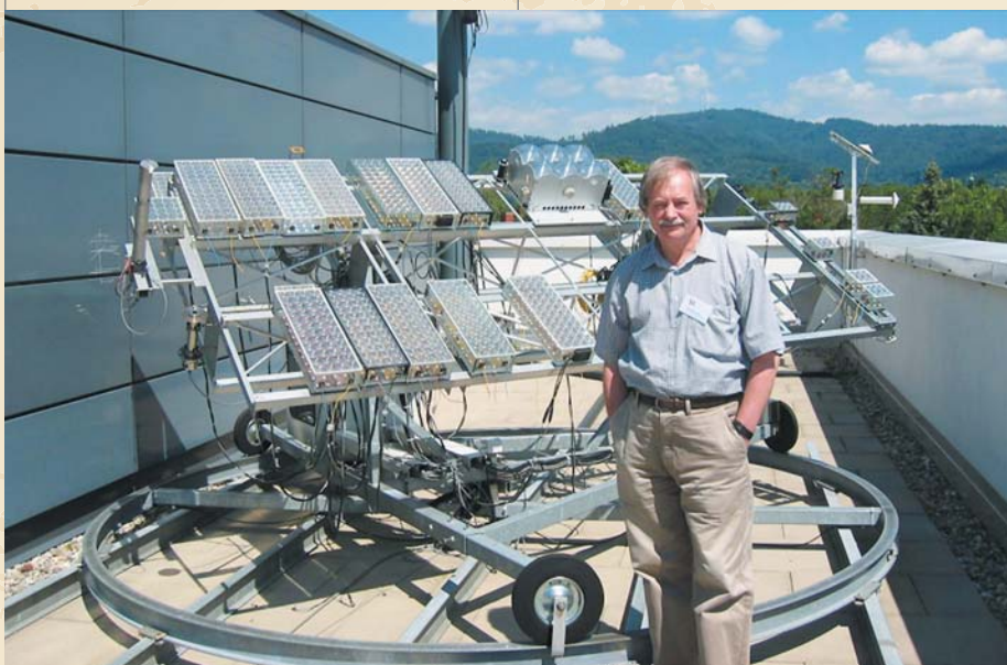
Рис. 5. Система слежения за Солнцем во Фраунгоферовском Институте солнечных энергосистем (г. Фрайбург), созданная профессором В. Д. Румянцевым (на фото), главным научным сотрудником ФТИ им. А. Ф. Иоффе. Предназначена для ресурсных испытаний концентраторных модулей, проводимых в FhG-ISE с 2000 г.
